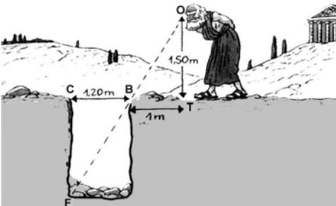
Calculer la profondeur du puits sur l'illustration ci-contre.
